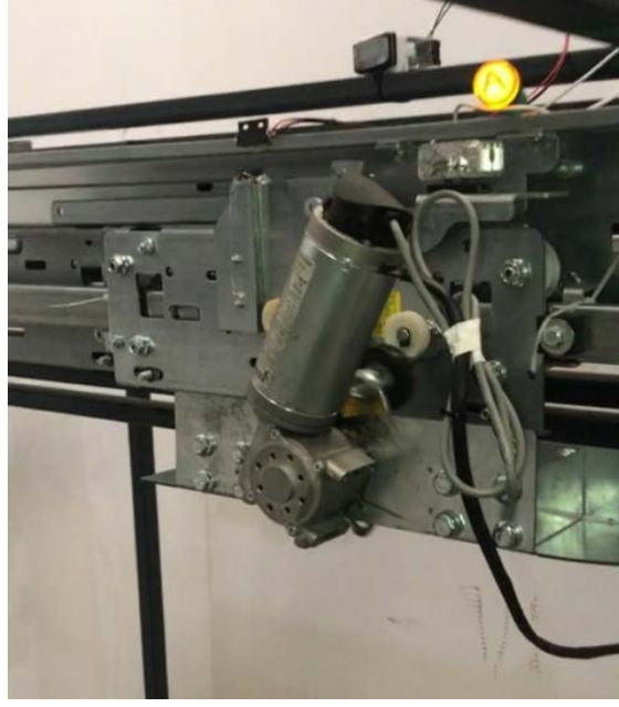
Resim 10. Dayanıklılık testi yapılan kat kapısı kilitleme tertibatı
