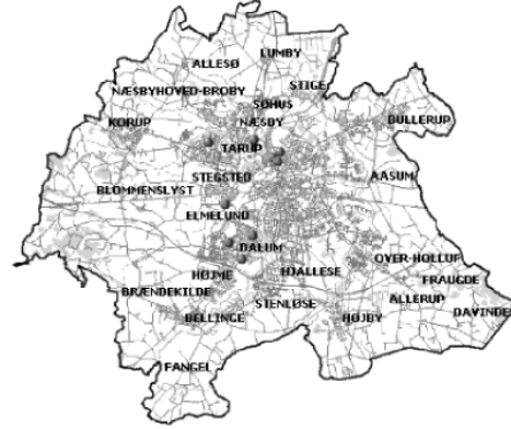
Şekil 12. Odense bölge ısıtma sistemi boru şebekesi [6].
